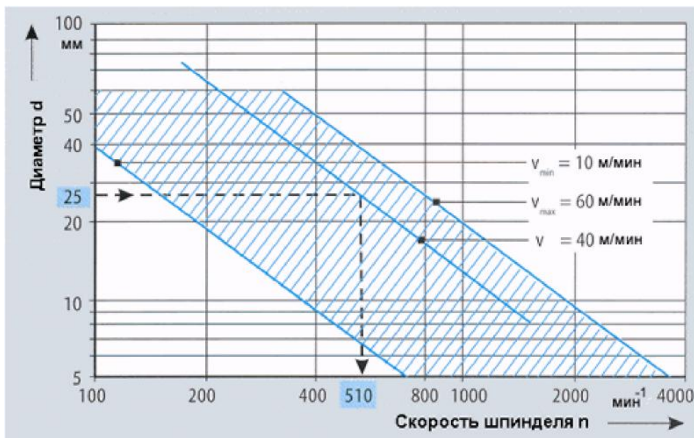
Рисунок 13 - Рекомендуемые скорости резки, диаметры и скорости вращения для сверления
