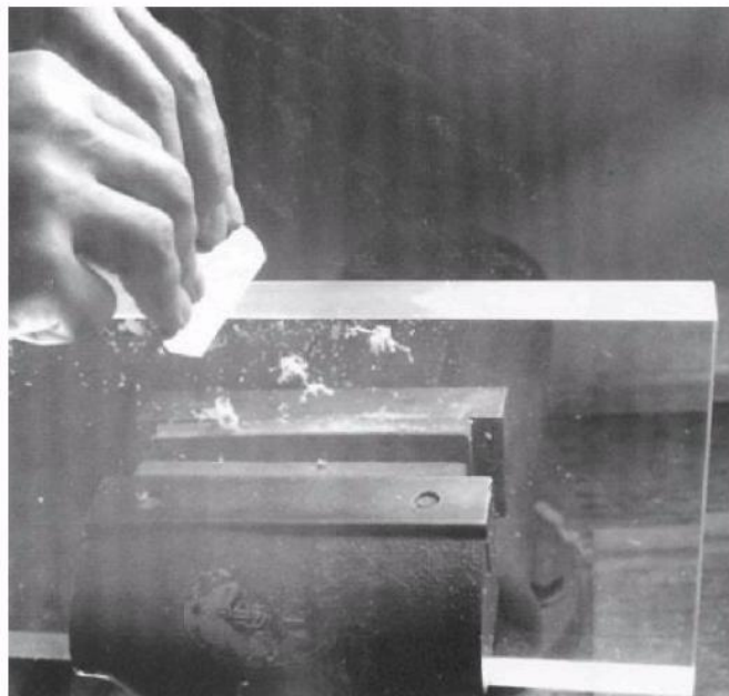
Рисунок 35 - Удаление заусенцев с поверхности PLEXIGLAS при помощи шабера
