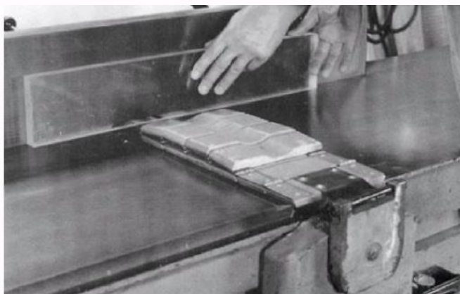
Рисунок 36 - Сглаживание торца на продольно - строгальном станке
